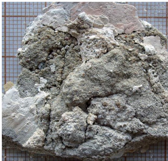
Fot. 4/5. Próbką wyprawy tynkarskiej C4 poddana analizie zasolenia – widok od lica i od strony tynku.
