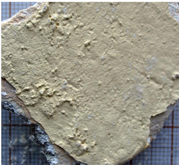
Fot. 4/5. Próbką wyprawy tynkarskiej C4 poddana analizie zasolenia – widok od lica i od strony tynku.
