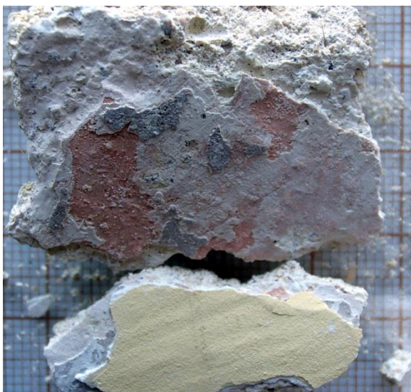
Fot. 2/3. Próbkę wyprawy tynkarskiej C3 poddana analizie zasolenia – widok od lica i od strony tynku.
